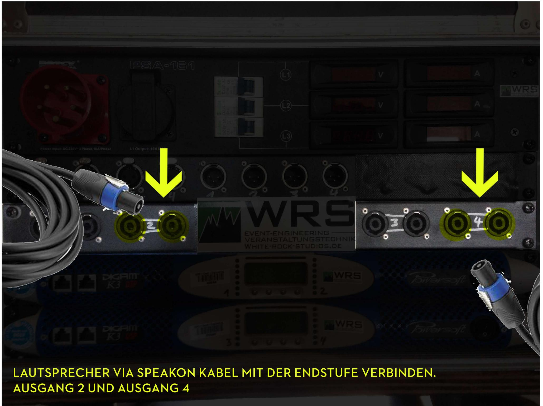
**LAUTSPRECHER VIA SPEAKON KABEL MIT DER ENDSTUFE VERBINDEN.
