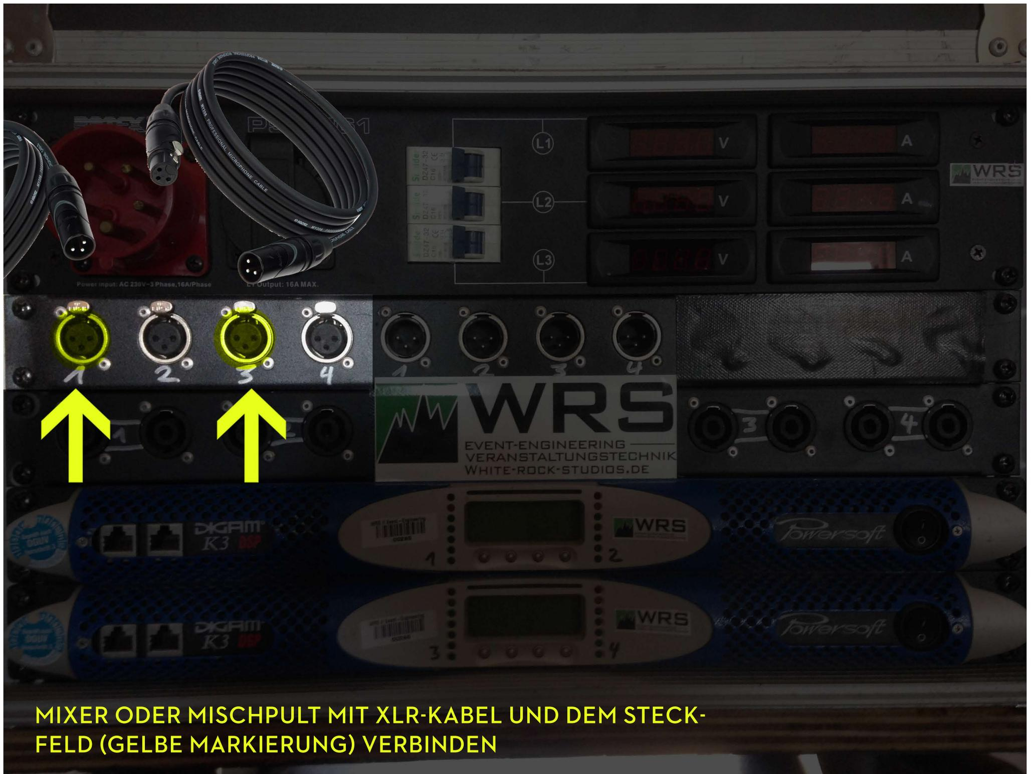
MIXER ODER MISCHPULT MIT XLR-KABEL UND DEM STECKFELD (GELBE MARKIERUNG) VERBINDEN
